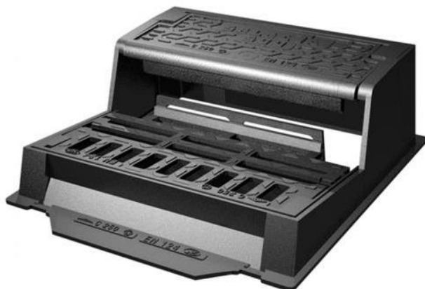
Foto 4810. Osaliselt rentsliis paiknev neeluluuk. Tugevusklass C 250. Neeluluuk fikseeritakse betoonpadjaga
