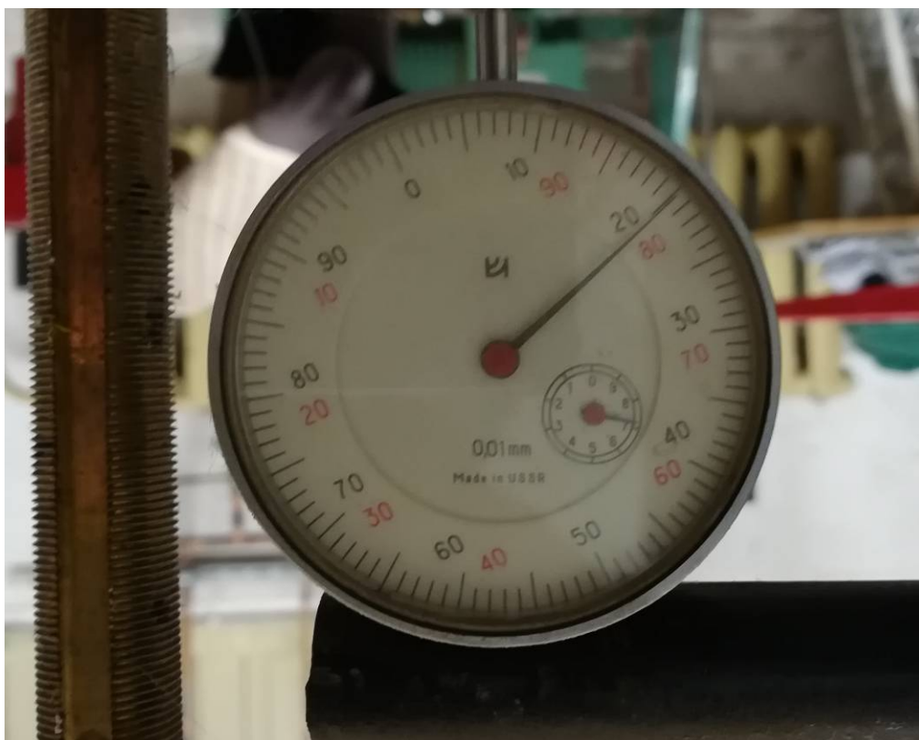
Marja reeperite kamber. Reeperite nr 4 ja nr 6 vaheline nihkeindikaator.
