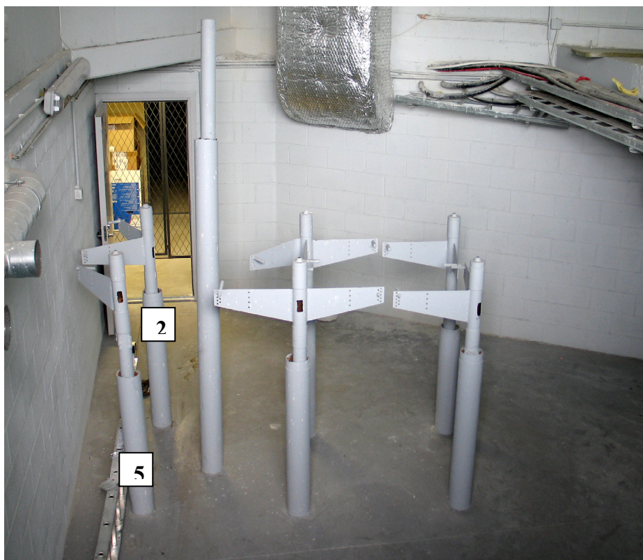
Foto 3. Viru reeperite kamber Viru keskuse keldris 2008.a. Vt reeperite nr 2 ja 5 tsentritorude keermest lahtiolekule viitavat kronšteinide asendi muutust võrdluses järgmise fotoga.
