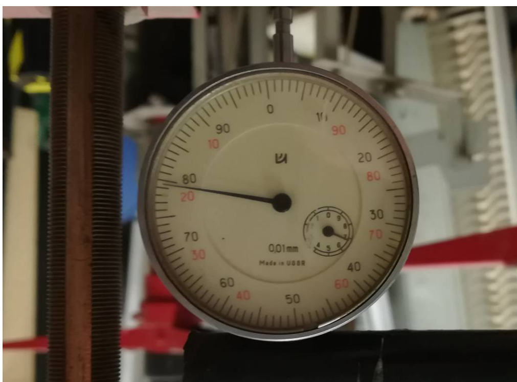
Marja reeperite kamber. Reeperite nr 2 ja nr 3 vaheline nihkeindikaator.
