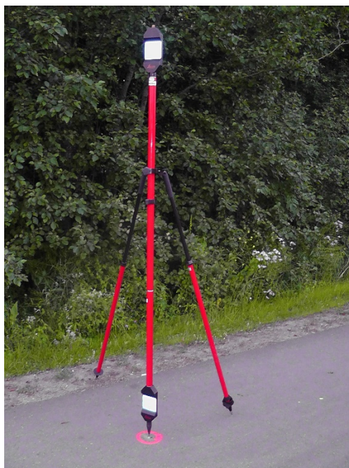
Joonis 8. „Twin Target“ tähis paigutatuna koordineeritud asfaldinaelale kõnnitees.
