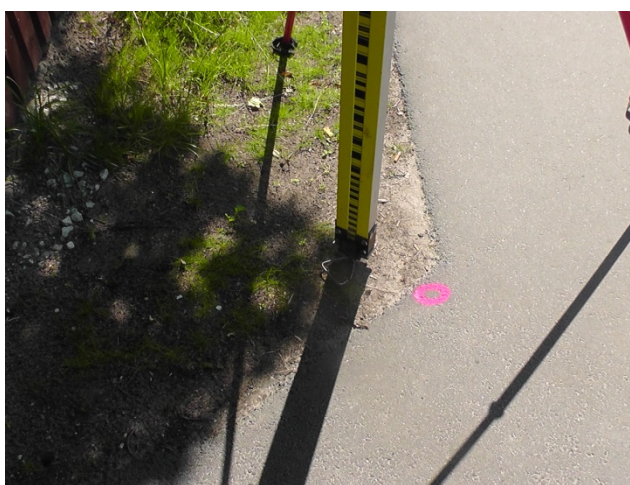
Joonis 14. Rõngaga metallvai invarlati alusena
