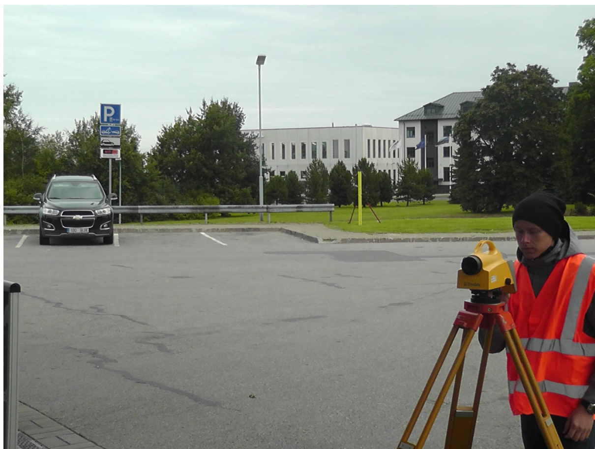
Joonis 6. Nivelleerimisel kasutatud digitaalnivelliir Trimble DiNi03 (esiplaanil) koos kasutatud invarlatiga (tagaplaanil)
