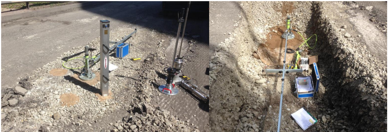
Joonis 2 ja 3. Mõõtmine killustiku pealt ja selle alt. Killustikukihi paksus oli ca 80 cm.
