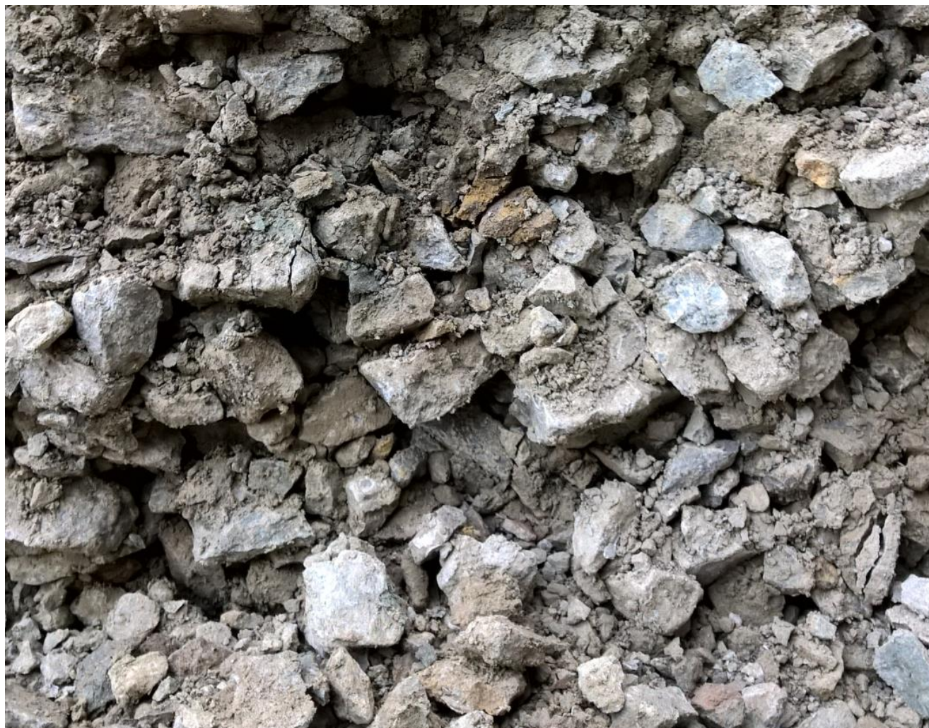
Joonis 14. Vanas killustikaluses olev killustik on lõhenenud, purunenud; palju leidub värskeid murdumispindu ja peent puru.
