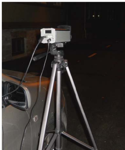
Kaamera LMK 98-3 on mõõtmisteks paigaldatud statiivile
