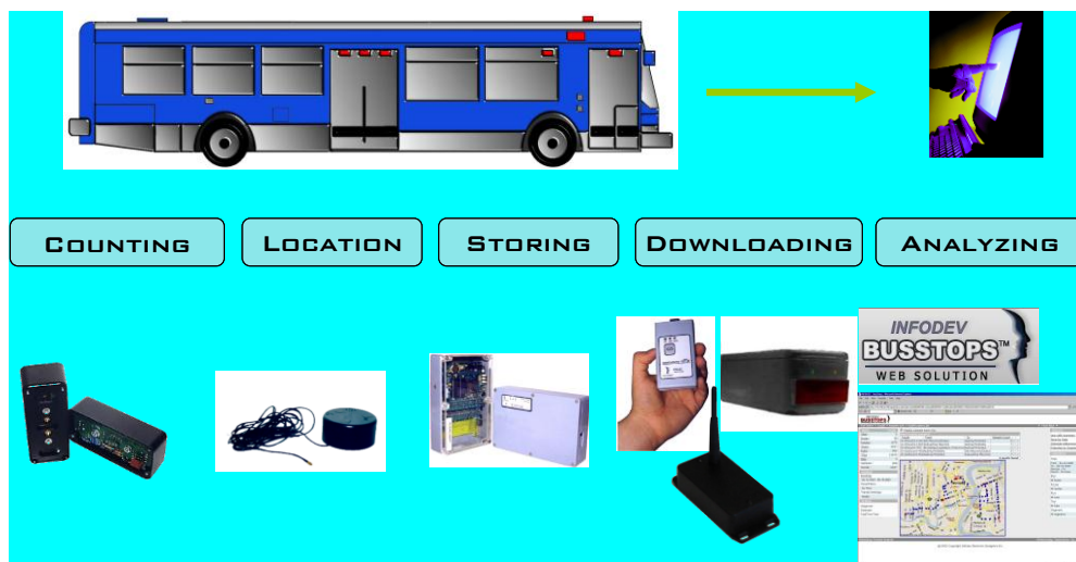
Joonis 12. SMILE projekti mahus rakendatud automaatse reisijateloenduse süsteemi ( Automatic Passenger Counters - APC ) rakendusskeem
