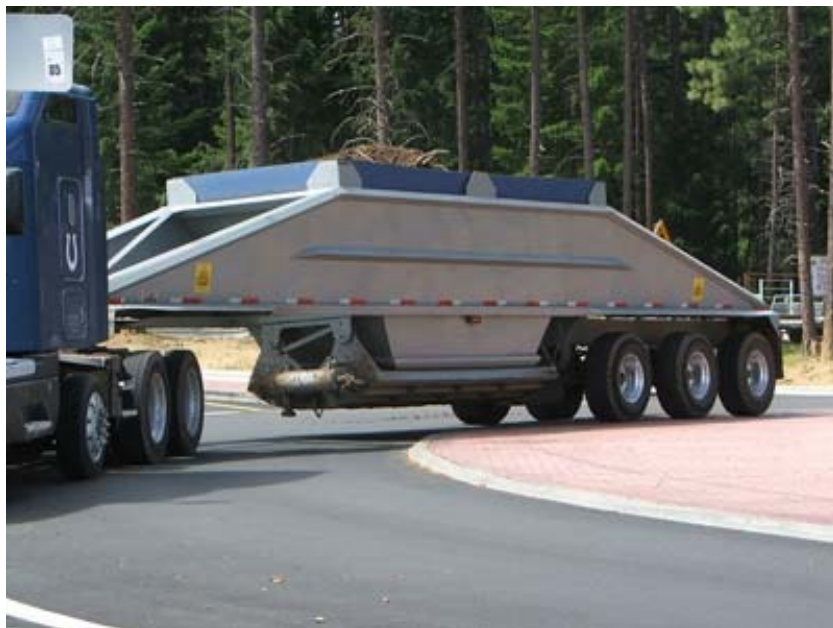
Joonis 4.6. Veok treileriga liigub tagumiste ratastega üle sõidutee kitsendi, tagades sellega veokile suurema pöörderaadiuse
