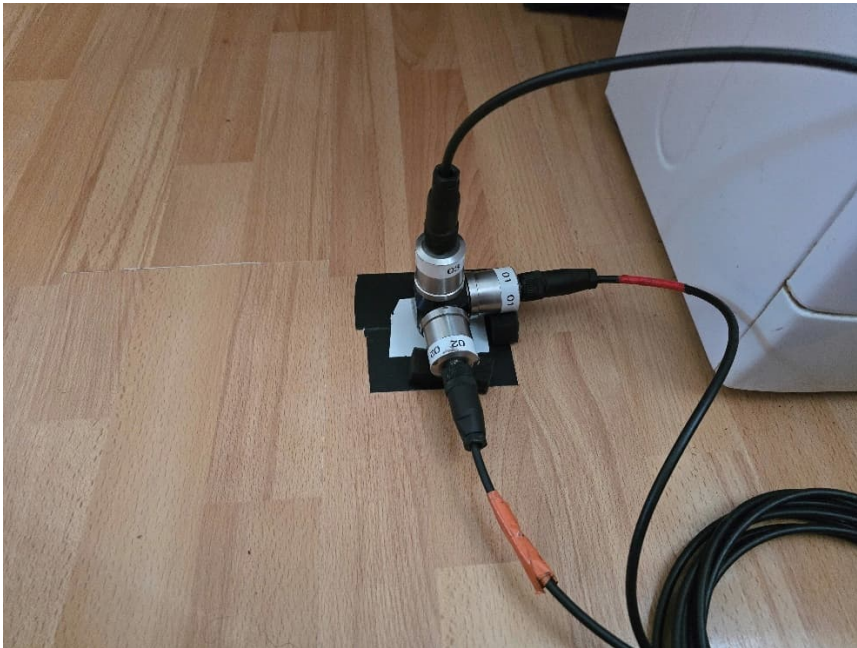
Foto 1. Mõõtmiste teostamise ajal paigaldatud vibratsiooniandurid
