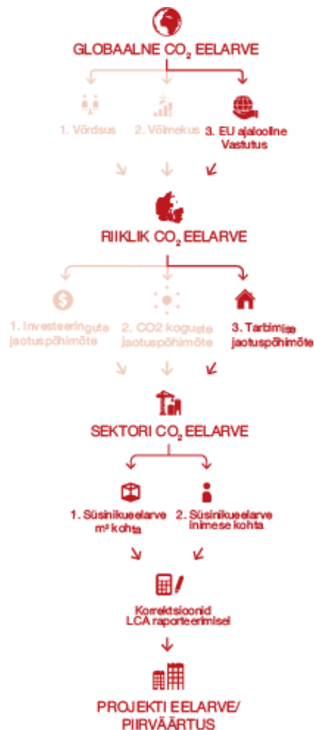
Joonis 4. Süsinikueelarve regulatiivsed tasandid. Andmed: Circular construction For Urban Development, lk 161
