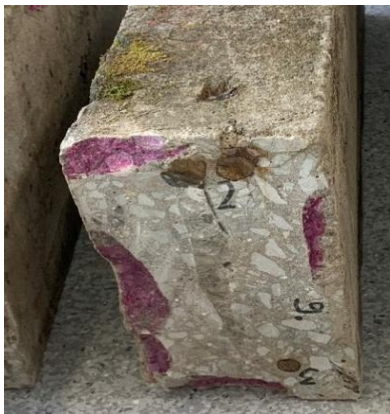
Foto 2. Betooni karboniseerumissügavuse mõõtmine lahtilöödud killu kaudu
