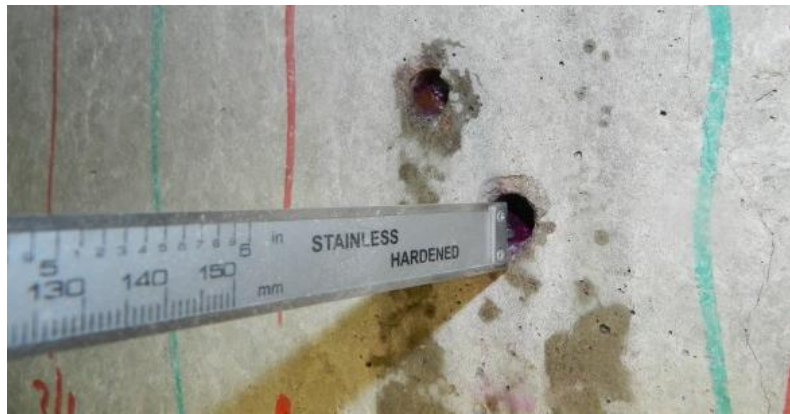
Foto 3. Betooni karboniseerumissügavuse mõõtmine ettepuuritud augu kaudu
