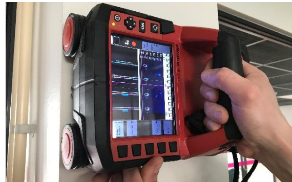
Foto 5. Terrassarruse paiknemine ja betoonist kaitsekihi mõõtmine seadmega Hilti PS 1000 X-Scan
