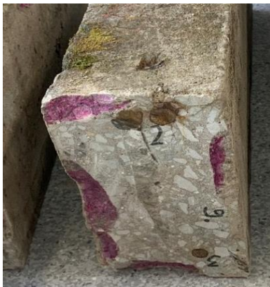
Foto 2. Betooni karboniseerumissügavuse mõõtmine lahtilöödud killu kaudu
