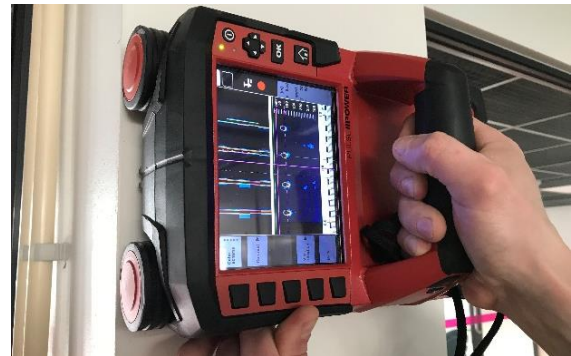
Foto 5. Terrassaruse paiknemine ja betoonist kaitsekihi mõõtmine seadmega Hilti PS 1000 X-Scan
