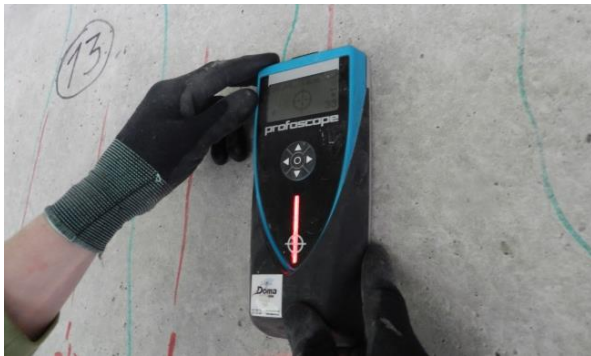
Foto 4. Terrassaruse paiknemine, betoonist kaitsekihi mõõtmine ja varda läbimõõdu määramine seadmega Proceq Profoscope+
