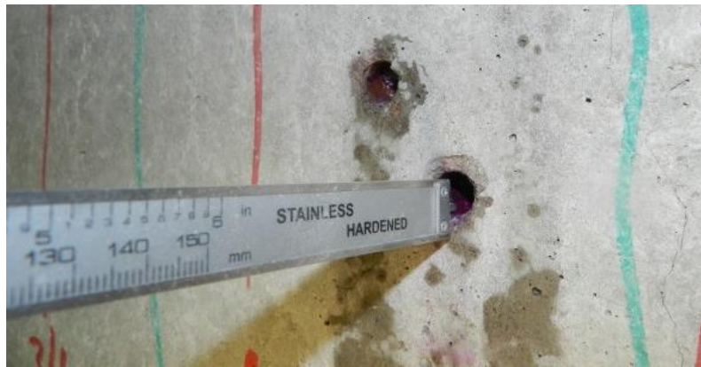
Foto 3. Betooni karboniseerumissügavuse mõõtmine ettepuuritud augu kaudu
