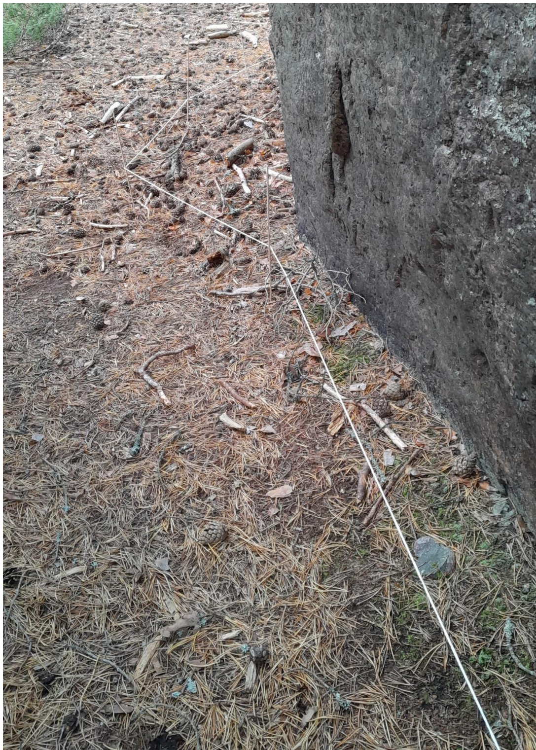
Joonis 1. Alt aheneva kivi suurima ümbemõõdu mõõtmine nõõri ja vaiade abil.
