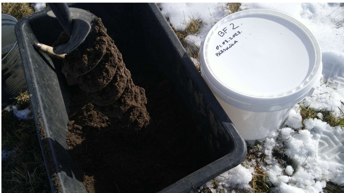
Joonis 5. Välja puuritud südamik koguti kokku, segati läbi ning sellest võeti ühendproov.
