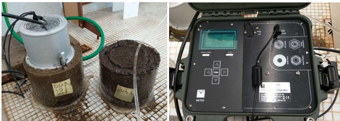
Joonis 2. Proovikeha ning seade infiltratsiooni määramiseks (imbumiskatse)
