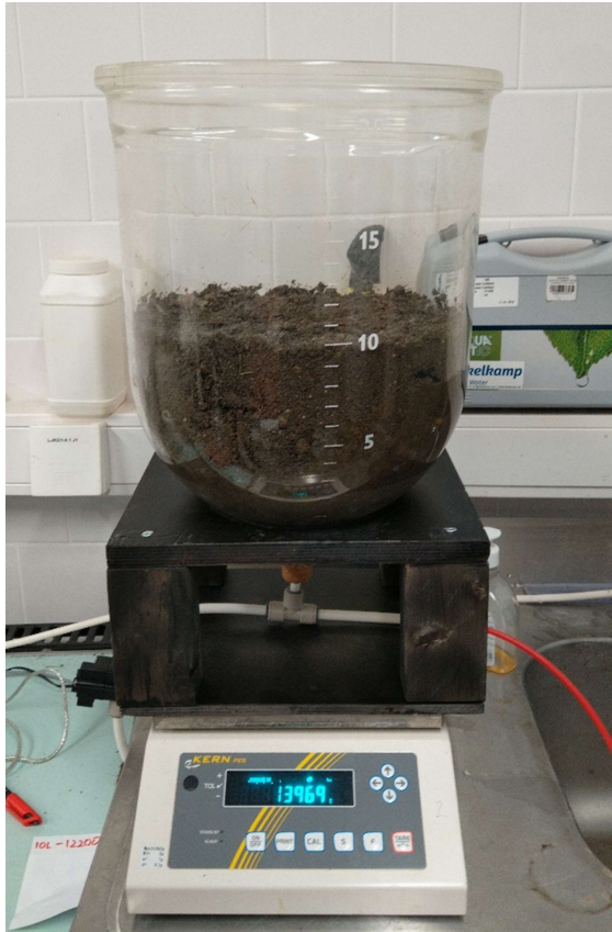
Joonis 1. Proovikeha stendil vee loovutamise kiiruse määramiseks (nõrgumiskatse)
