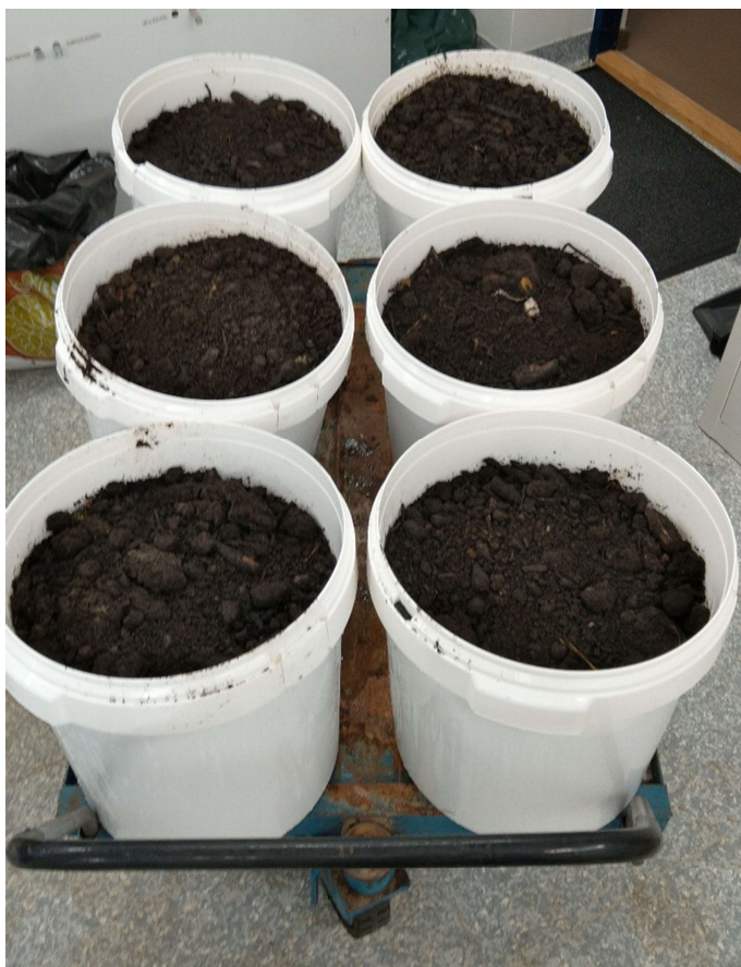
Joonis 9. Biofiltritesse pandud materjali laadung EMÜ laboris. Materjal, millega täideti katsekolonn.
