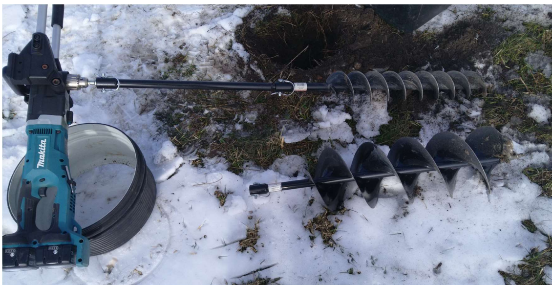
Joonis 4. Proovivõturiistad pinnase puurimiseks Pääsküla prügilas. Puurid \varnothing 100 ja \varnothing 200 mm, pikendusvarras 50 cm, puurimissügavus 70-80 cm.
