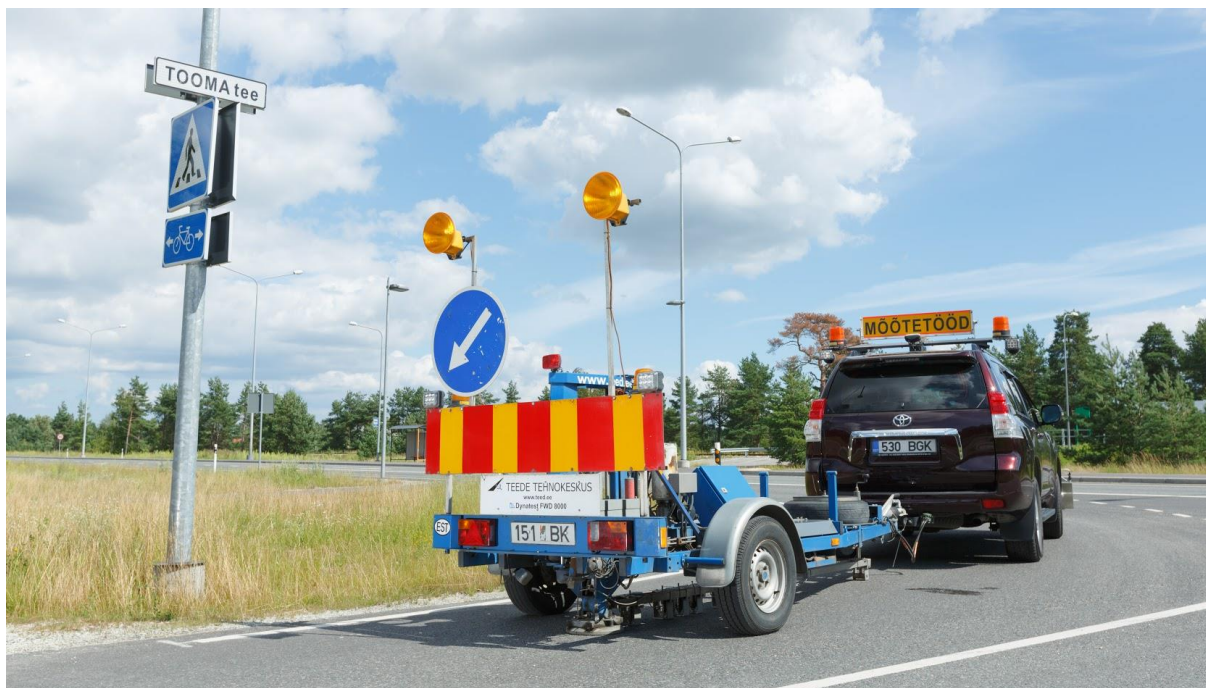
Joonis 3: Kandevõime mõõtmisel kasutatud koormusseade Dynatest FWD-8002
