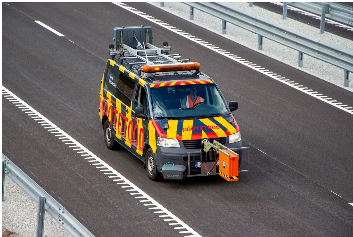
Joonis 4: Kattekihi paksuse mõõtmisel kasutatud maaradar GSSI SIR-30 mõõtebussil
