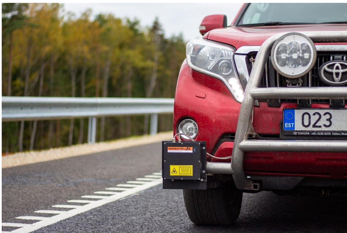
Joonis 2: Tasasuse ja tekstuuri mõõtmiseks kasutatud seade LTM-1
