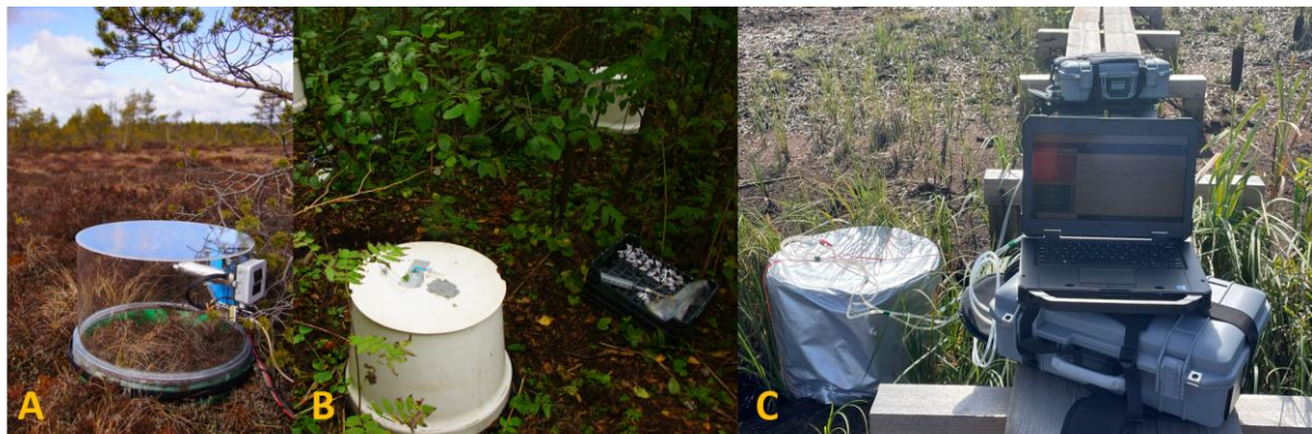
Joonis 2. Süsiniku bilansi mõõtmiseks läbipaistev kambrid (A), pimekambrid gaasipudelitega (B) ja portatiivsed analüsaatorid (C).
