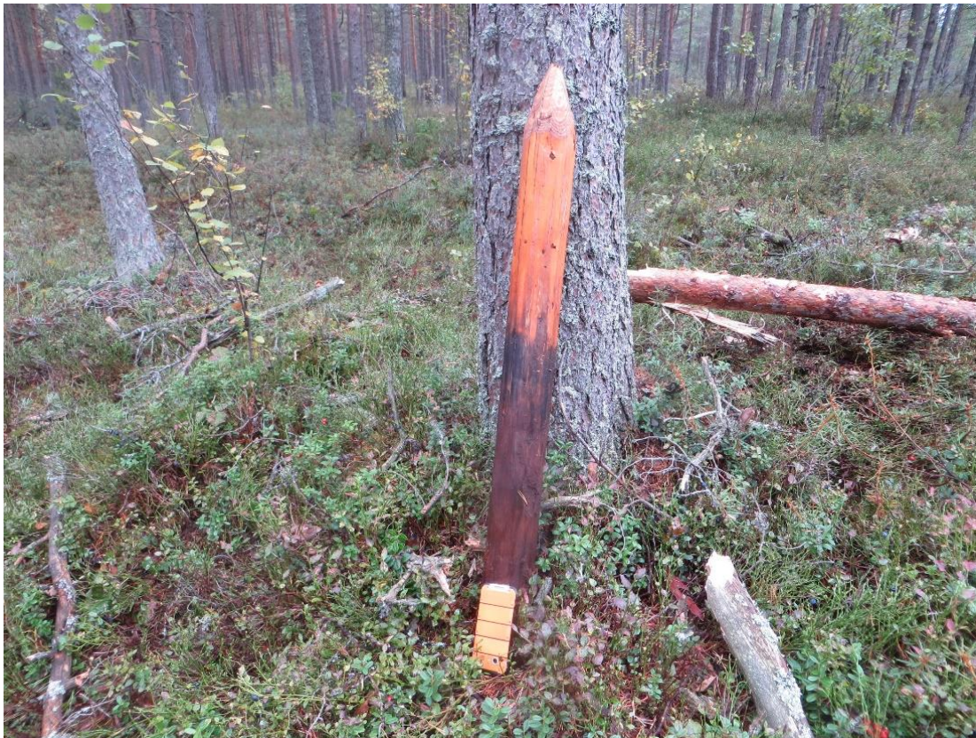
Joonis 9. Lahemaal Rahvuspargist, Laukasoo turbast leitud vai, mis oli tõenäoliselt ligikaudu 100 a eest ehitatud turbakuuri osa ja paiknes soovees hapnikuvaeses keskkonnas. Vaia ülemine osa, mis oli kuivas pinnasekihis, oli kõdunenud - teatud osa sellest oli ladestunud varisena, teine osa lendunud puidu lagundajate poolt CO 2 na atmosfääri. Foto: J.-O. Salm
