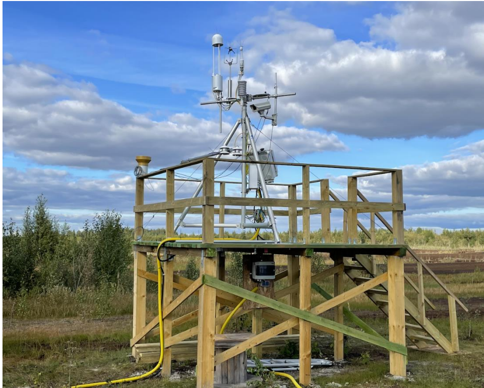
Joonis 3. Turbulentsete kovariatsioonide meetodil toimiv seirejaam Lavassaare ammendunud freesturbaväljal 2022. a.
