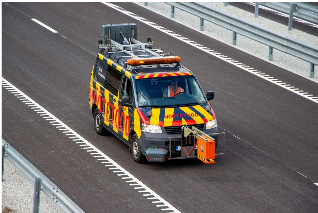
Kattekihi paksuse mõõtmisel kasutatud maaradar GSSI SIR-30 mõõtebussil
