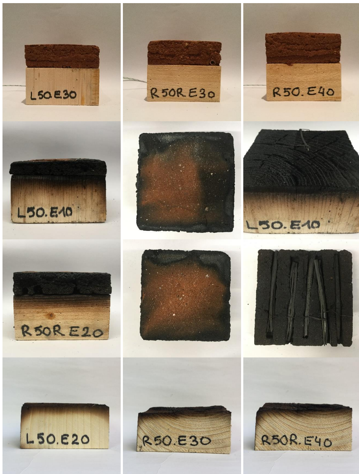
Foto B.1 Savikrohvi katsekehad enne ja pärast katset.
