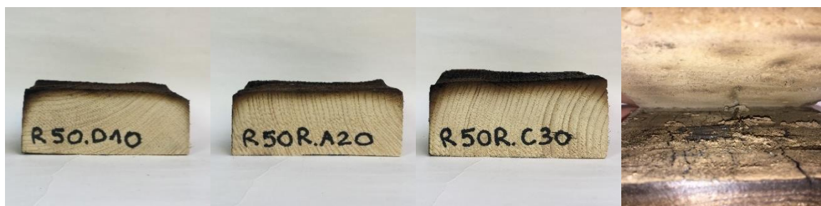
Foto 4.4 Lubikrohvi katsekehade jääkristlõige ja 40 mm krohvi puhul peaaegu olematu söekiht.
