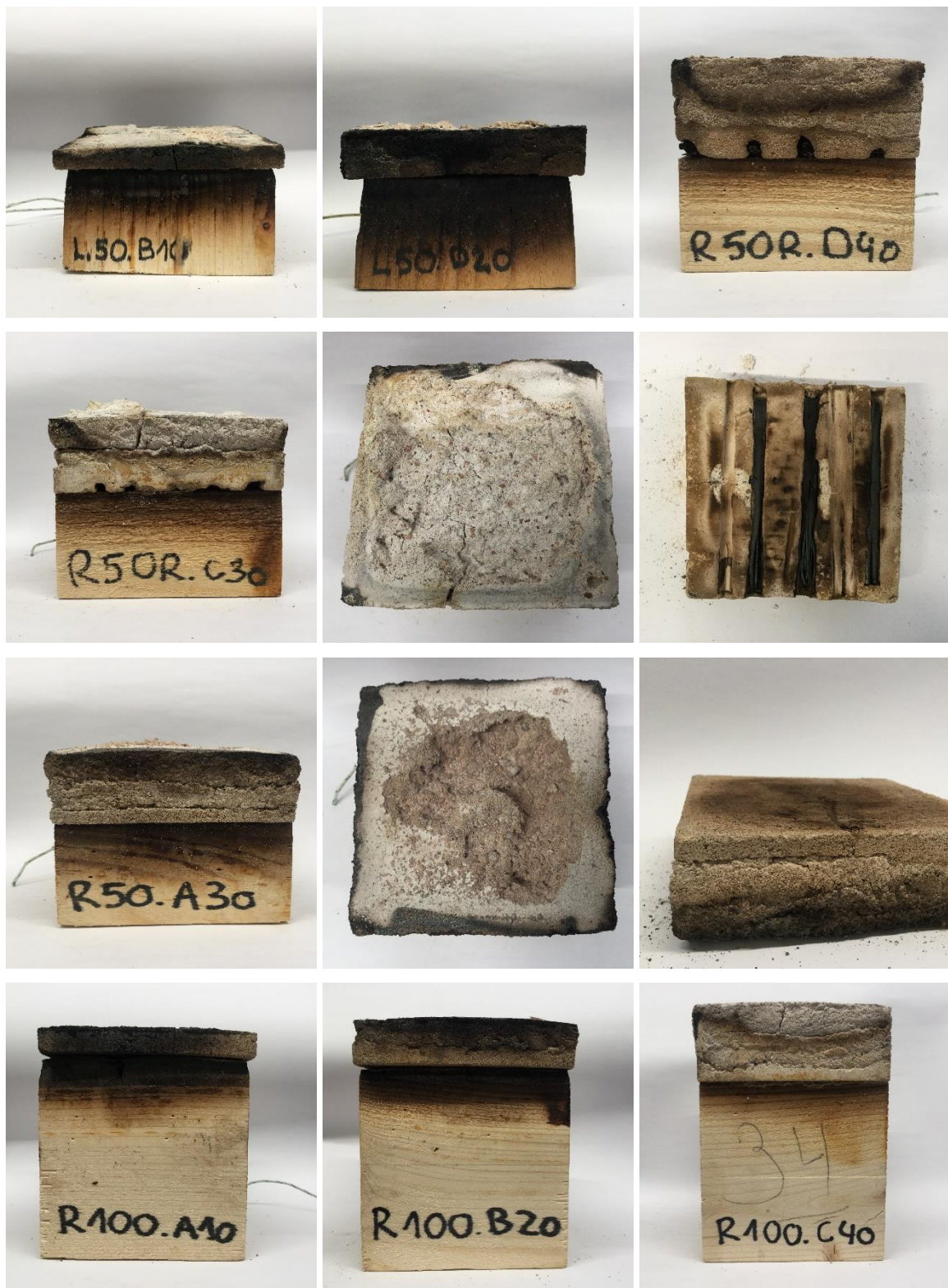
Foto A. 1 Lubikrohvi katsekehad pärast katset.
