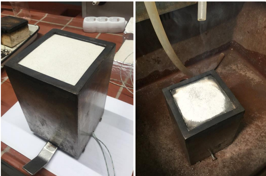
Foto 3.7 Katsekeha metallraamis enne ja pärast tulekatset.
