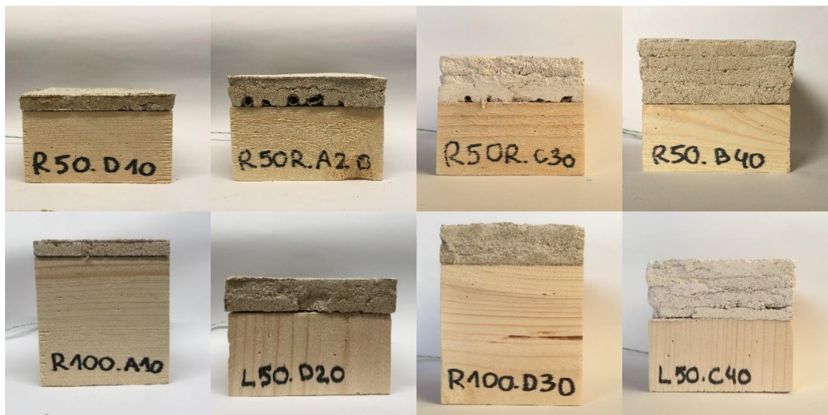
Foto 3.4 Lubikrohvi katsekehad enne katset.
