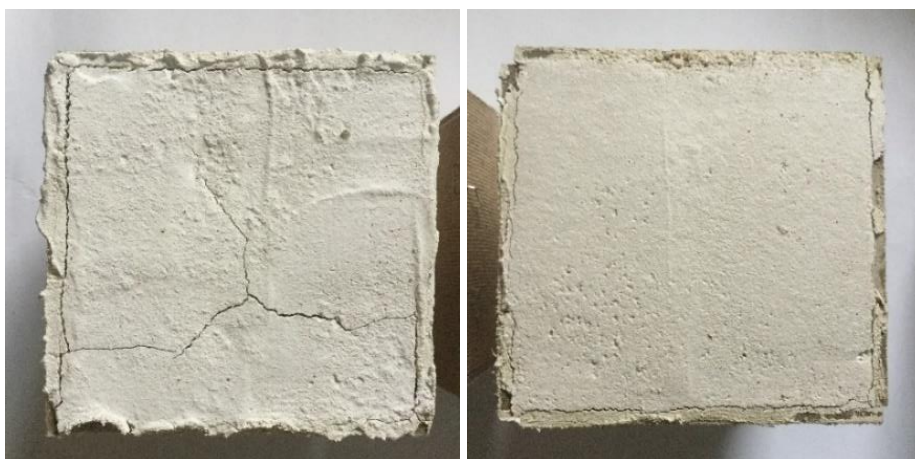
Foto 3.5 Katsekehad pärast krohvimist, vasakul pragunenud krohv C ja paremal krohv B.
