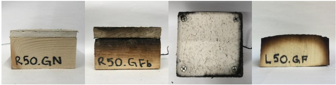
Foto C.1 Kipsplaadi katsekehad enne ja pärast katset.
