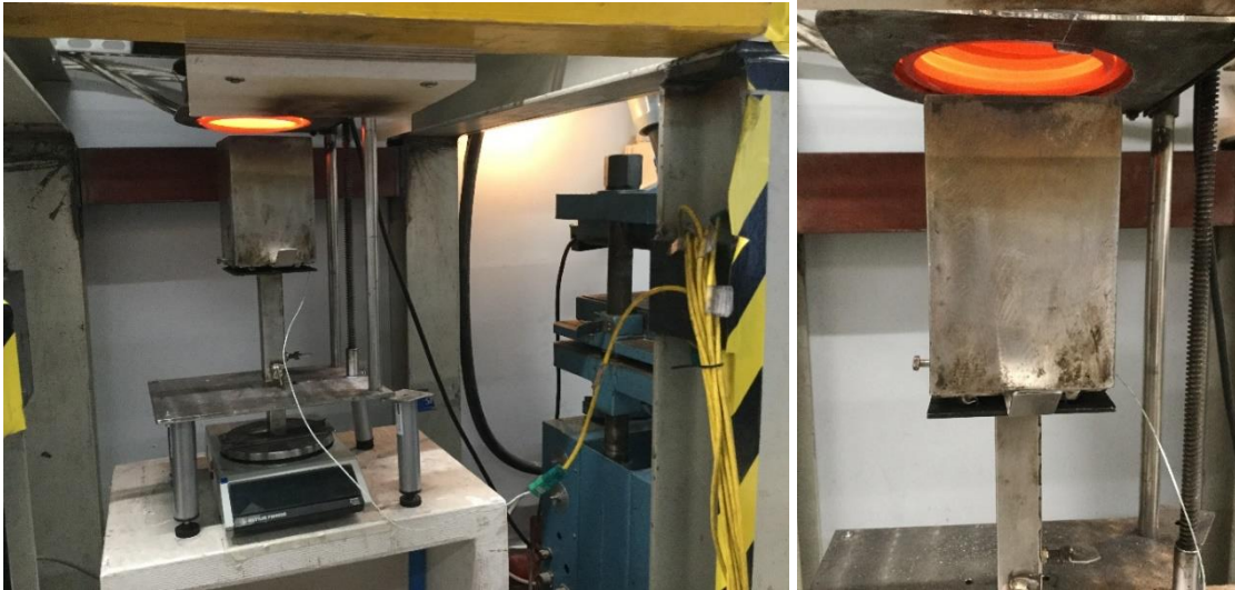
Foto 3.6 Katseseade ja katsekeha paigutus koonuskuumuti all.
