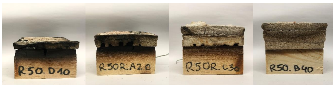
Foto 4.3 Lubikrohvi katsekehad pärast katset.
