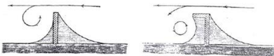
Joonis 4: Skeem hoovuste mõju ja sette liikumine sadamarajatiste läheduses
