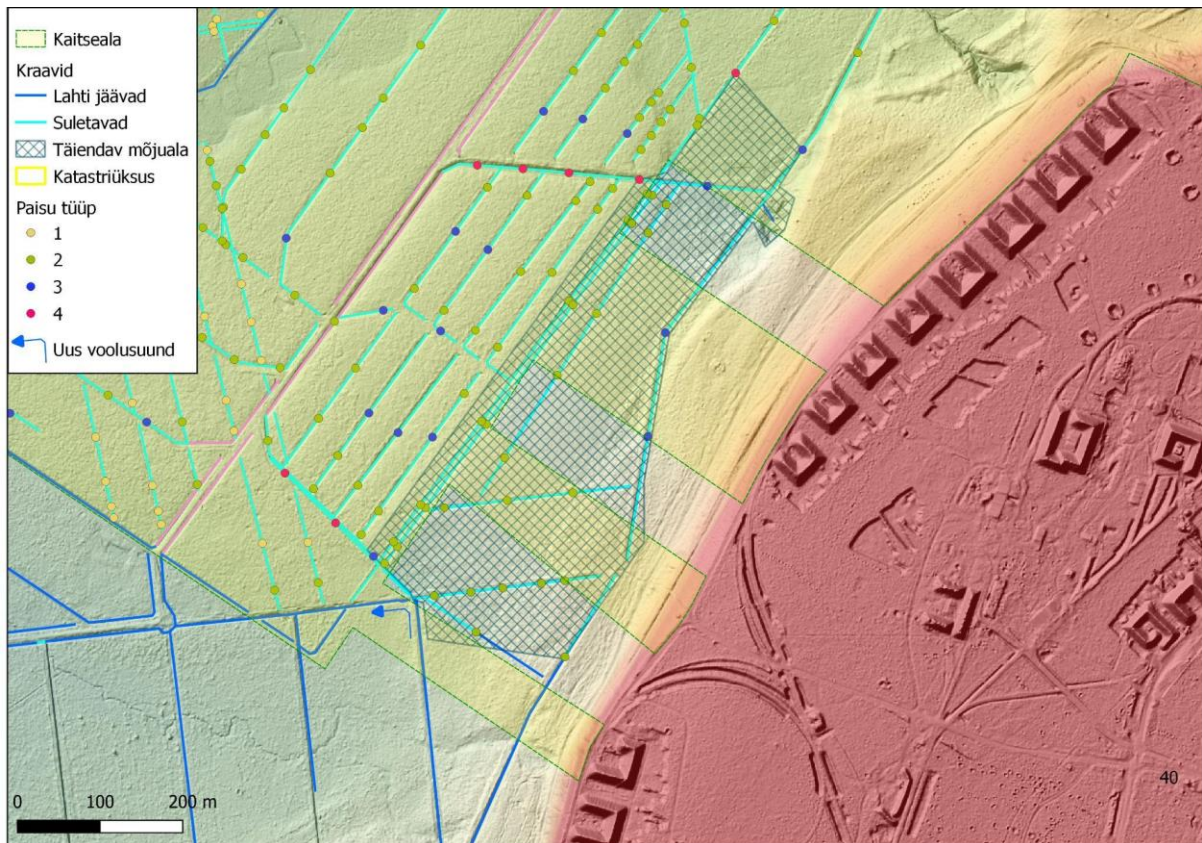
Joonis 10. Kaitseala kaguküljel olevate, era- ja riigimaid läbivate kraavide sulgemise skeem ja mõjuala, kui saadakse maaomanike nõusolek kraavide sulgemiseks teostamiseks. Ümber tuleb suunata Kerbu allikate juurest algav kraav noolega näidatud suunas.
