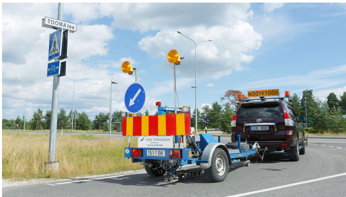
Joonis 5: Kandevõime mõõtmistel kasutatud koormusseade Dynatest FWD-8002
