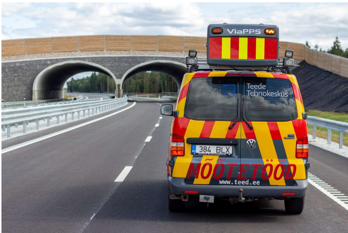
Joonis 4: Roopa mõõtmise seade ViaPPS
