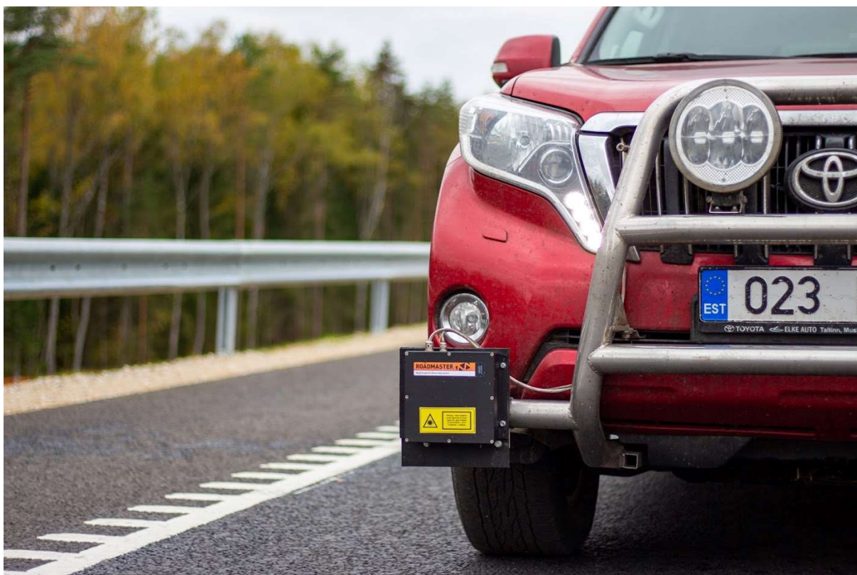
Joonis 2: Tasasuse ja tekstuuri mõõtmisteks kasutatud seade LTM-1
