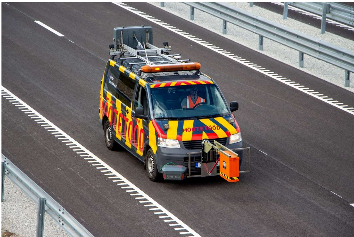
Joonis 6: Kattekihi paksuse mõõtmisel kasutatud maaradar GSSI SIR-30 mõõtebussil
