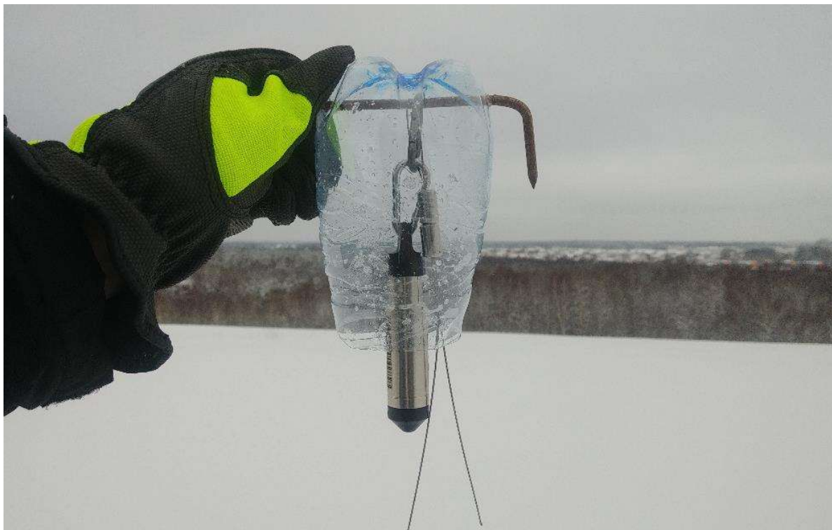
Foto 8. Nõrgvee seirekaevu LW-3 paigaldatud automaatne õhurõhu mõõtja
