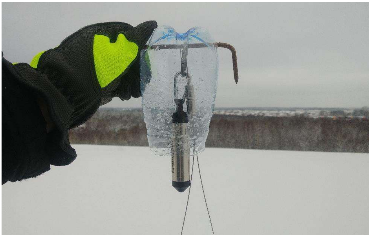
Foto 19. Nõrgvee seirekaevu LW-3 paigaldatud automaatne õhurõhu mõõtja
