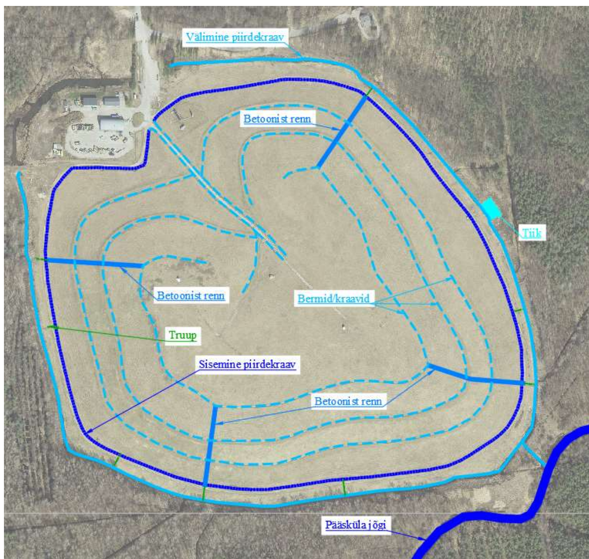
Skeem 1. Pääsküla prüügila sademeveesüsteem
