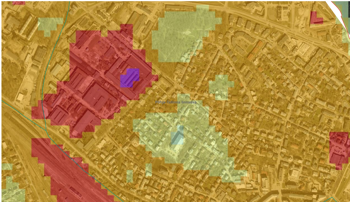
Joonis 1.9. Pinnatemperatuurid Kalamajas 3. juulil 2021. Pildi keskosas on Salme kultuurikeskus koos ümbritseva pargiga, mille pinnatemperatuuriks oli 29,5 °C. vasemal üleval on Volta kvartal, kus Uus-Volta tn 2a katuse (sinist värvi pikslid) temperatuuriks oli 46,2 kraadi.
