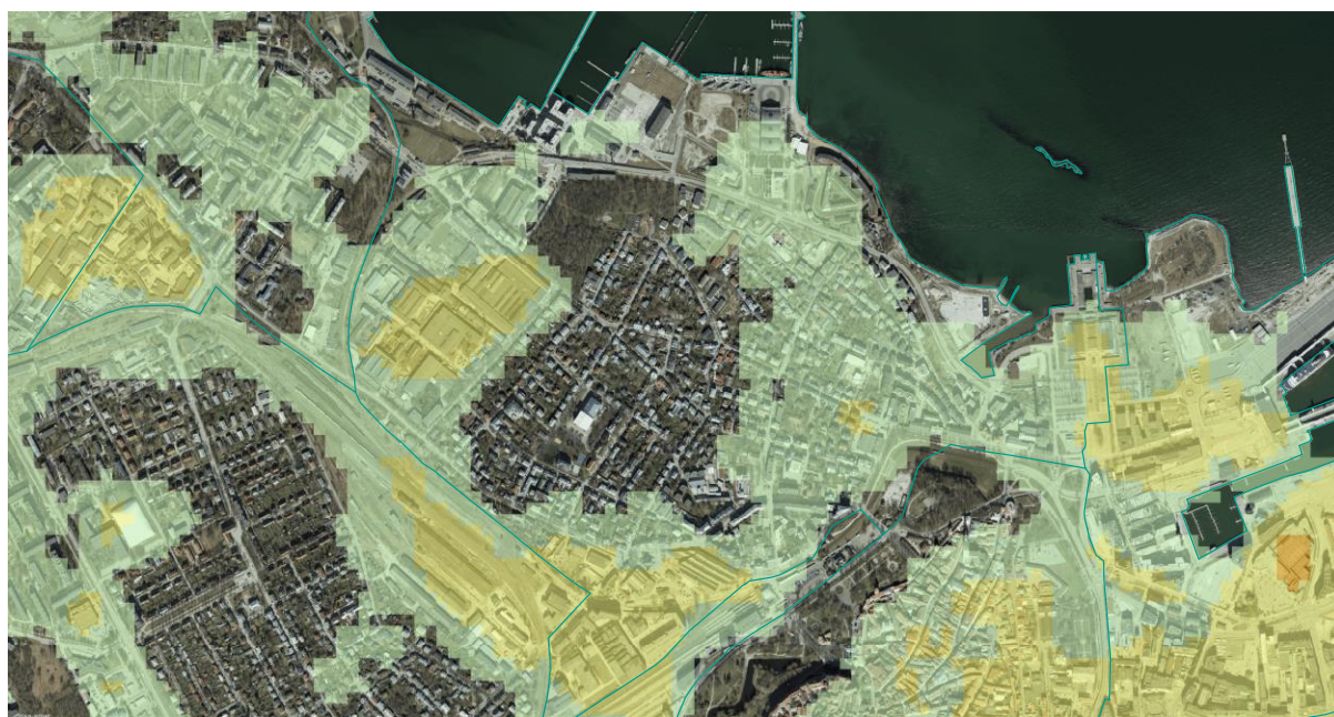
Joonis 1.5. 3. juunil 2021 kl 12:30 Landsat 8 poolt pildistatud pinnatemperatuuride klassid asetatuna Maa-ameti aerofoto kohale. Joonise keskel on Kalamaja asum. Toonimata alade pinnatemperatuur on vähem kui 27 °C. Roheka tooniga on temperatuuriklass 27-30 kraadi; kollane: 30-35 kraadi. Tallinn-Harku ilmajaamas oli õhutemperatuur sel hetkel 18 °C.
