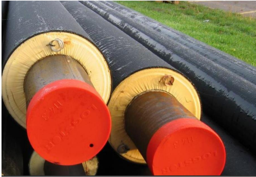
Joonis 2.8. Eelisoleeritud seotud (konsolideeritud) terastorustik [13]
