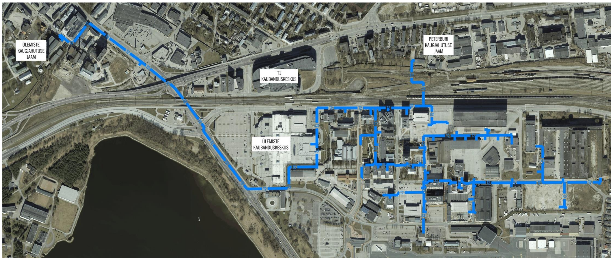
Joonis 4.1. Ülemiste City kaugjahutuse masterplaan / torustiku plaan
