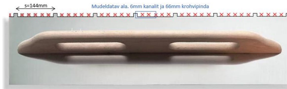
Joonis 27. PCM krohvi sisse difusioonikanalite loomiseks kasutatava 12x12mm hammastega segukammi kontseptsioon
