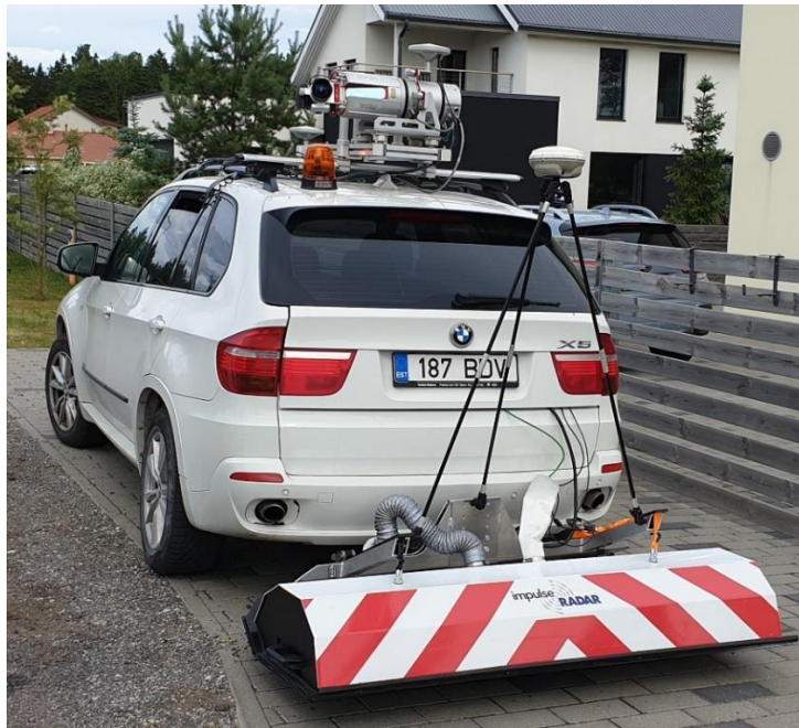
Pilt 13: ImpulseRadari georadar koos Riegl 3D mobiilse laserskanneriga
