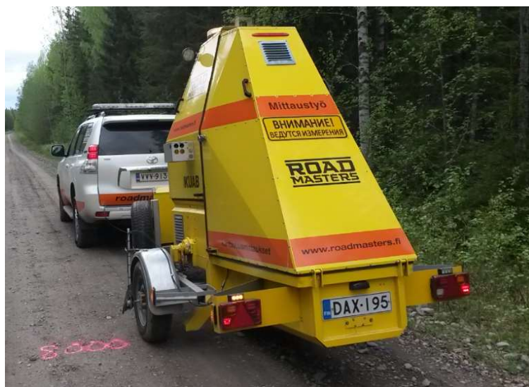
Joonis 5. Teekonstruktsiooni kandevõime mõõtmise seade KUAB 50 (FWD)
