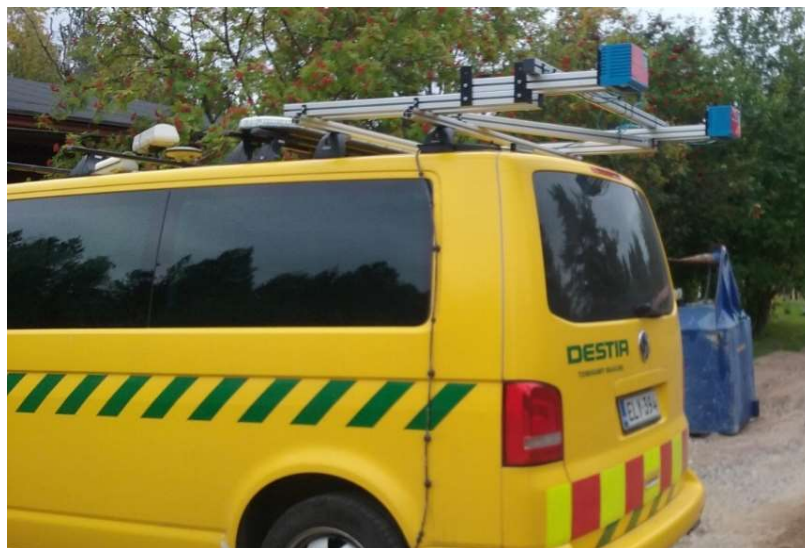
Joonis 4. Teekatte roopa sügavuse mõõtmise seade SICK LMS400 laser scanner
