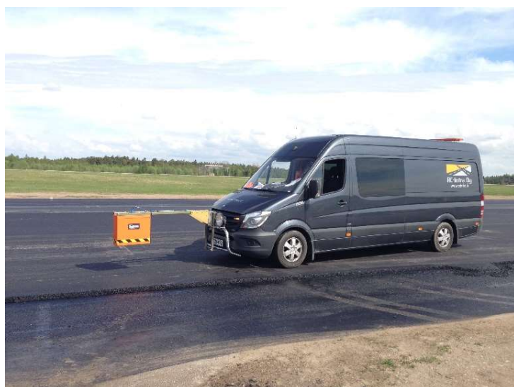
Joonis 6. Maaradariga GSSI SIR-30 ja mõõteantenniga varustatud mõõtebuss
