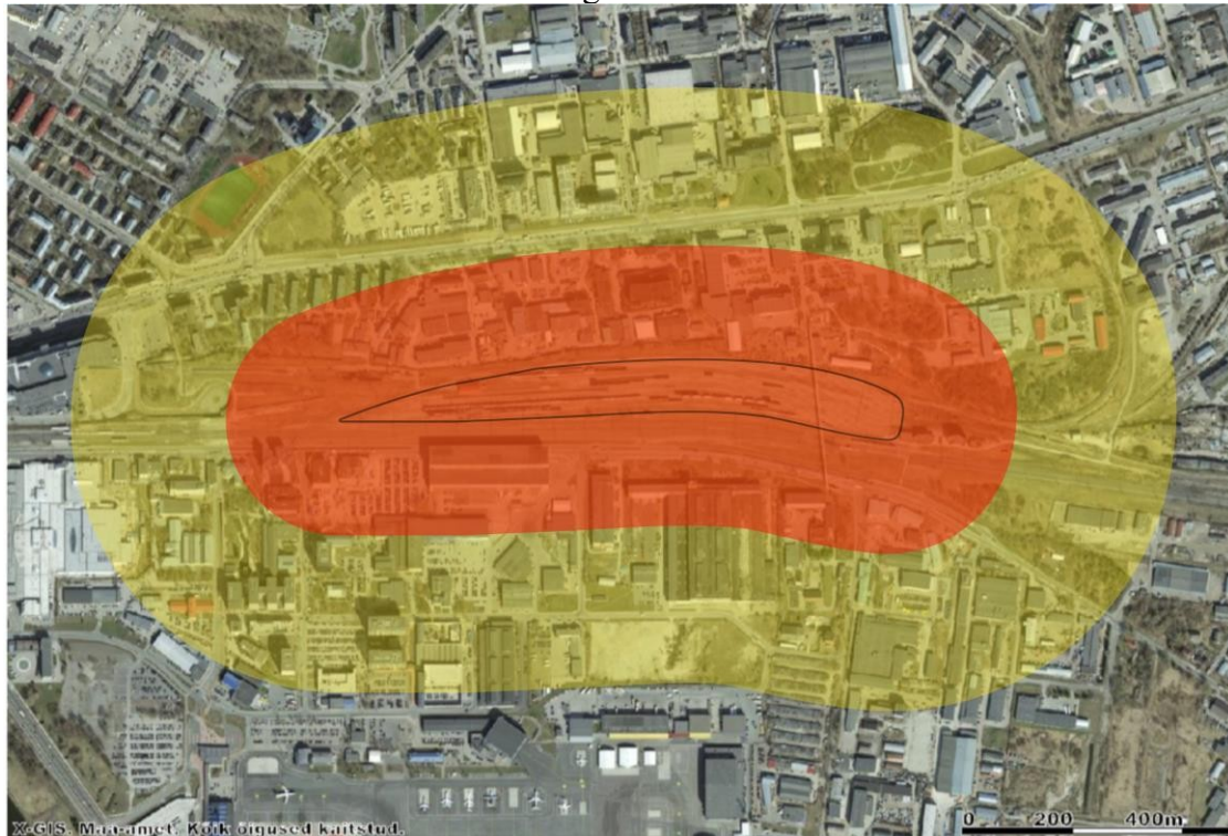
Joonis 4. Ülemiste jaama bensiinitsisterni BLEVE soojuskiirguse ohuala ehitistele: 221 m ja inimestele: 505 m.
