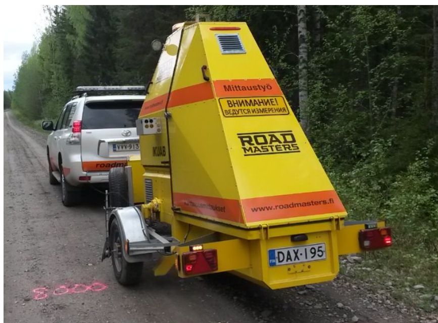
Joonis 4. Teekonstruktsiooni kandevõime mõõtmise seade KUAB 50 (FWD)
