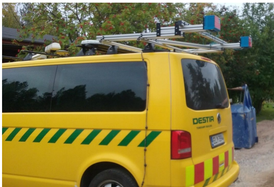
Joonis 3. Teekatte roopa sügavuse mõõtmise seade SICK LMS400 laser scanner
