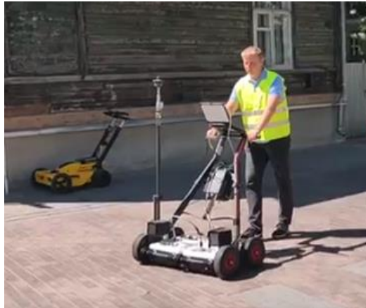
Pilt 18. Olav Harjo IDS RIS MF Hi-Mod testimisel Vesivärava tn-l
