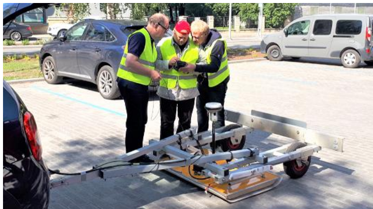
Pilt 20. Emmanuel Thibaut, Andres Kärk ja Raul Rökk 3D-Radar GeoScope testimisel Vesivärava tn-l
