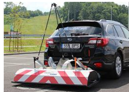
Pilt 3. 18 kanaliga 3D GPR
