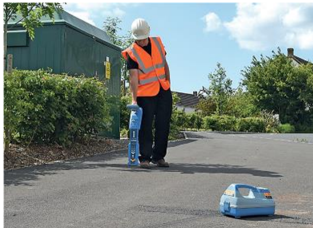
Pilt 12. Uuring induktsiooniga läbi maapinna (TSA, 2018 19 )
