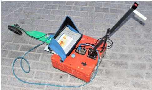
Pilt 15. Georadar GSSI SIR 3000 ja 270 MHz antenn
